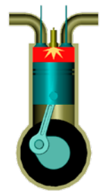
OTTO-Motor: interne Verbrennung OTTO-engine: internal combustion
